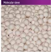
granule 2,5 - 5,0 mm Shape Bulk density 0,7 kg/l
